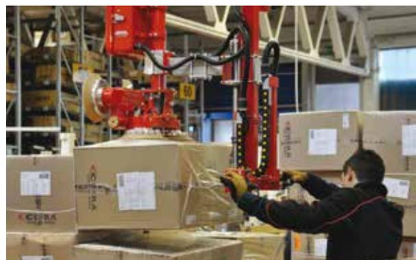
Il cartone viene etichettato automaticamente, rivestito di un film di sicurezza che ne garantisce la sigillatura ed una maggiore resistenza agli agenti atmosferici e posizionato sulle pedane mediante un sistema di manipolazione che permette all'operatore di evitare il sollevamento di pesi, riducendone l'affaticamento.
