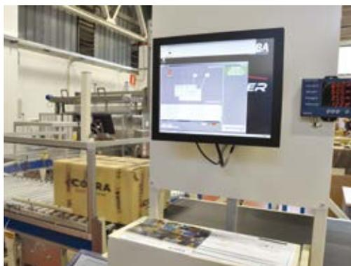
Peso e volume vengono verificati per controllare la conformità rispetto ai dati teorici e riportati sulla etichetta applicata al cartone. In caso di difformità, il cartone viene scartato e ricontrollato.
